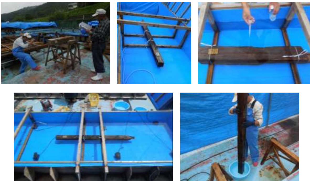
部材の塩分除去試験
