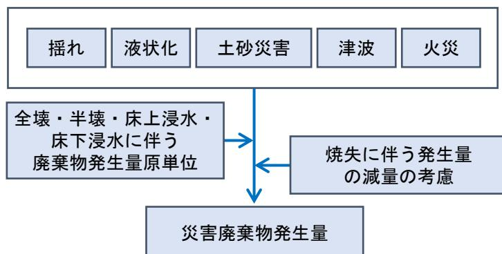
図 3.3.5-1 災害廃棄物の被害想定フロー
