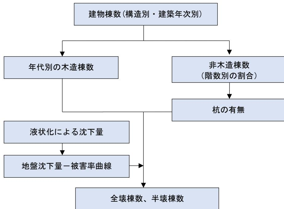
図 3.2.4-1 液状化による建物被害予測フロー
