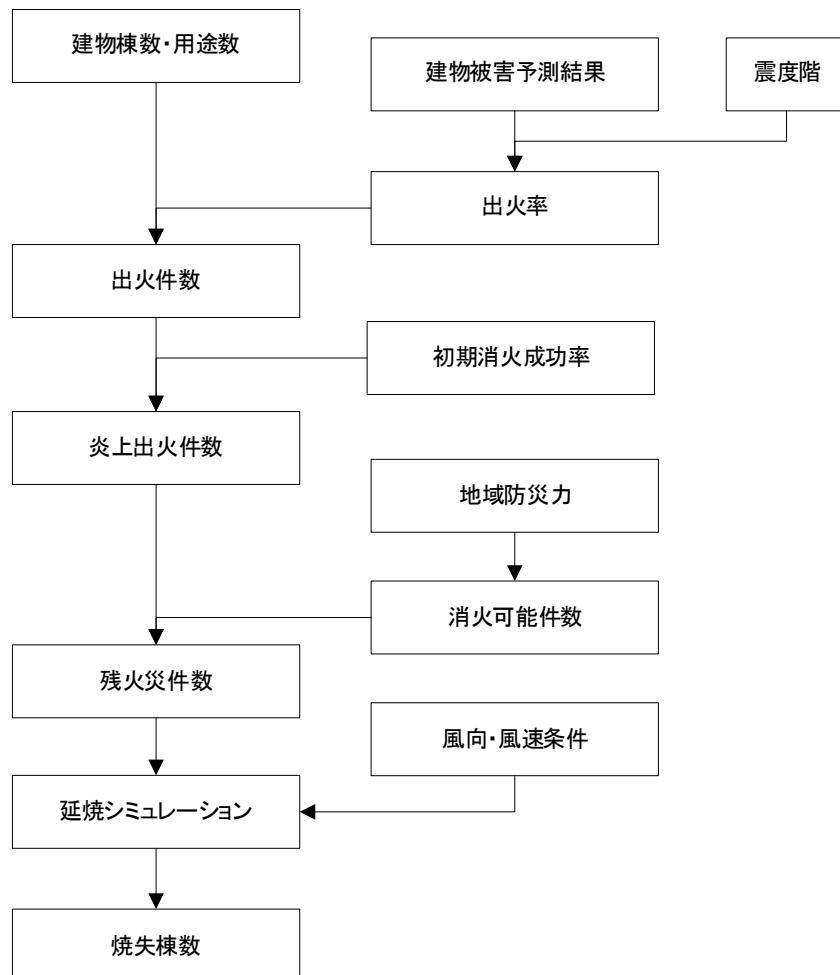
図 3.2.2-1 地震火災による被害予測フロー
