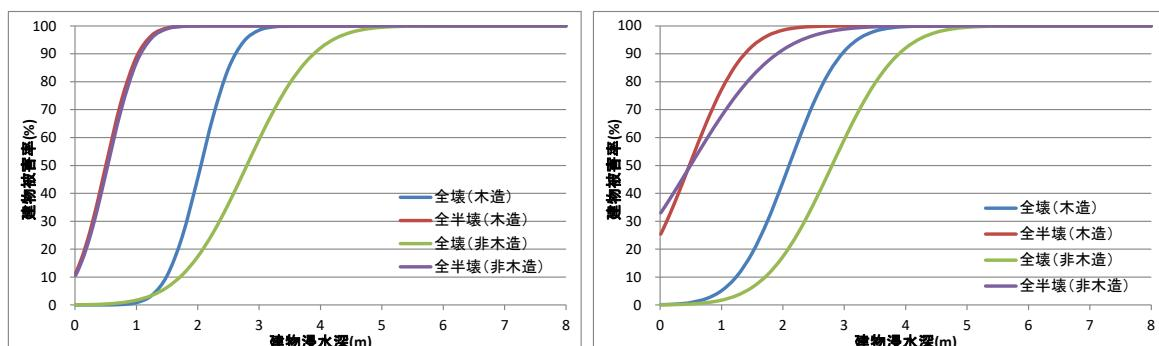
図 3.1.1-2 津波による建物被害率曲線(左：人口集中地区、右：人口集中地区以外)
