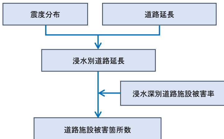
図 3.3.3-2 津波による道路施設被害箇所数の算定フロー
