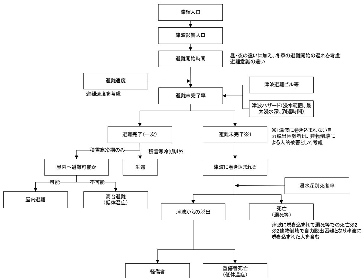
図 3.1.2-1 津波による人的被害予測フロー
