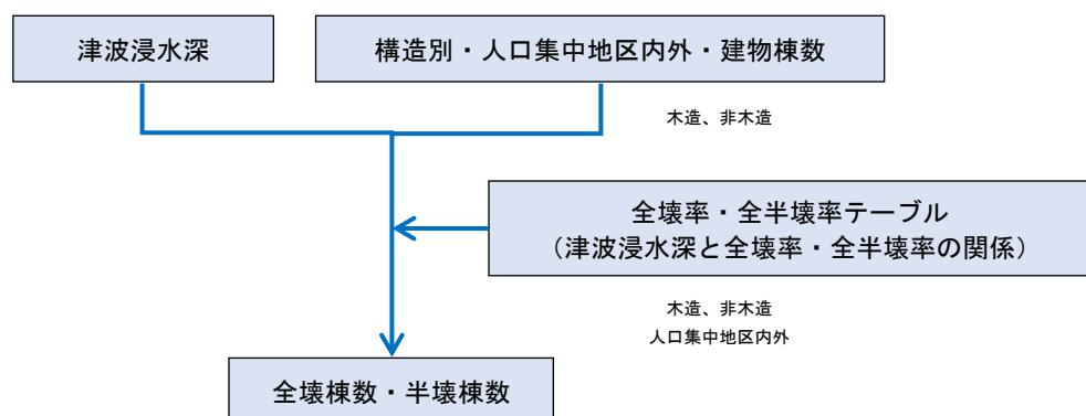
図 3.1.1-1 津波による建物被害の予測フロー
