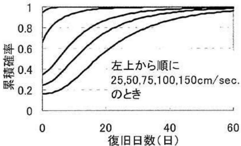
図 3.3.1-3 下水道の供給率復旧曲線 (日下ほか, 2011)
