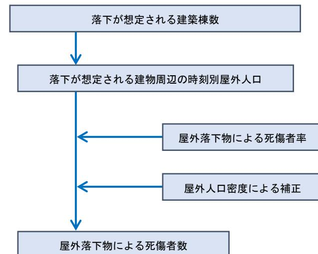
図 3.2.10-3 屋外落下物による死傷者数の予測フロー
