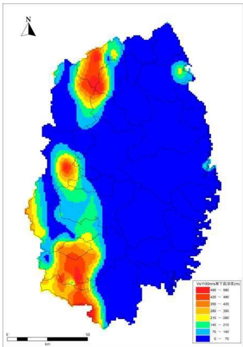
図 2.6.1-2 Vs1100m/s 層の下面深度 (m)
