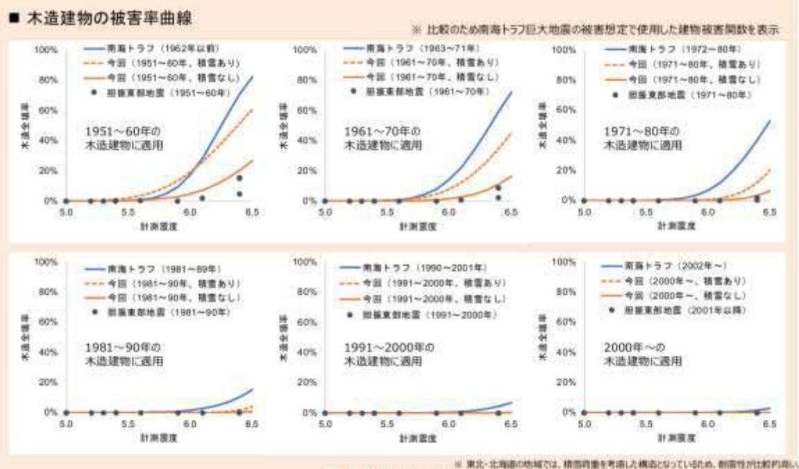
図 3.2.1-2 計測震度-被害率曲線（木造建物）
