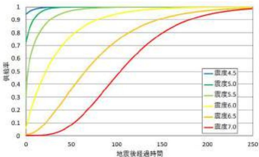
図 3.3.1-5 電力の計測震度に対する供給率曲線の予測
