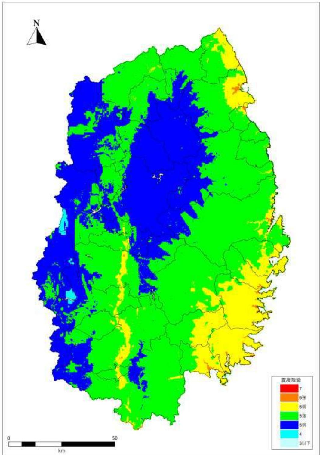
図 2.6.2-8 「日本海溝（三陸・日高沖）モデル」の最大となる地表震度分布図
