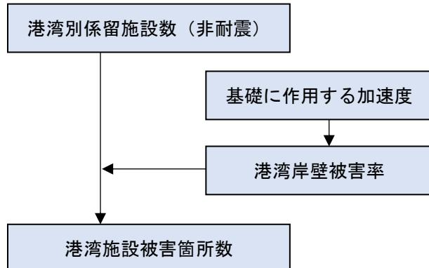
図 3.3.3-8 港湾施設の被害予測フロー
