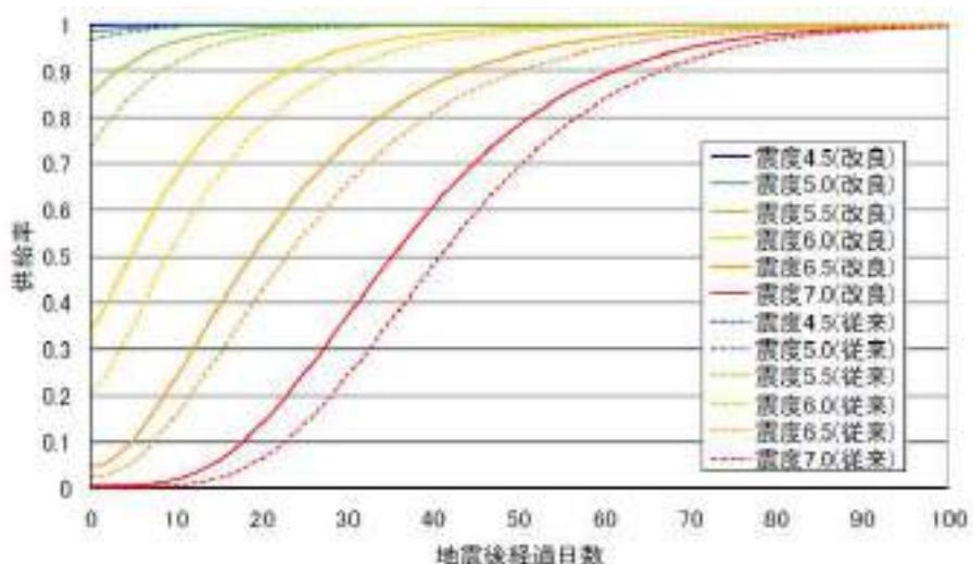
図 3.3.1-2 上水道の計測震度に対する供給率曲線の予測（能島ら, 2012<sup>vii</sup>）
