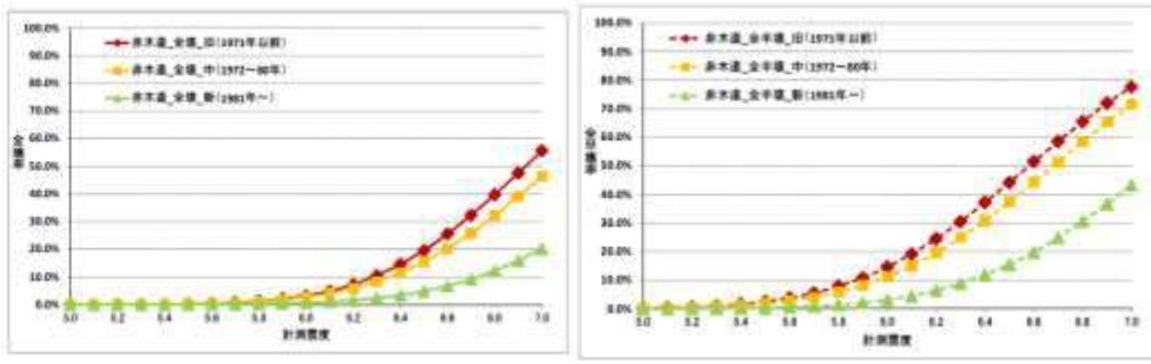
図 3.2.1-3 計測震度-被害率曲線（非木造建物）
