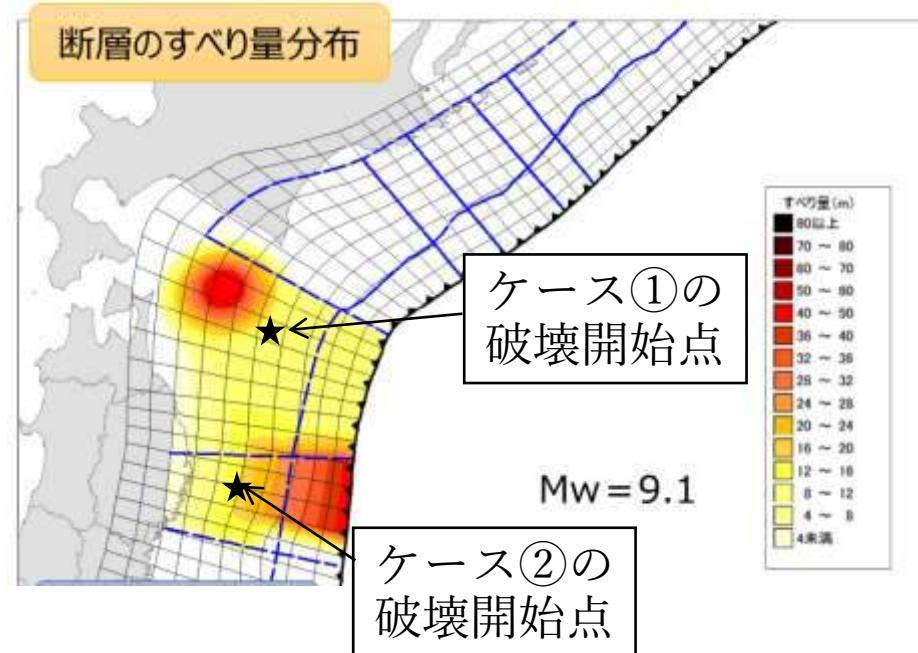
図 2.5-1 a. 日本海溝（三陸・日高沖）モデルの津波波源モデル
