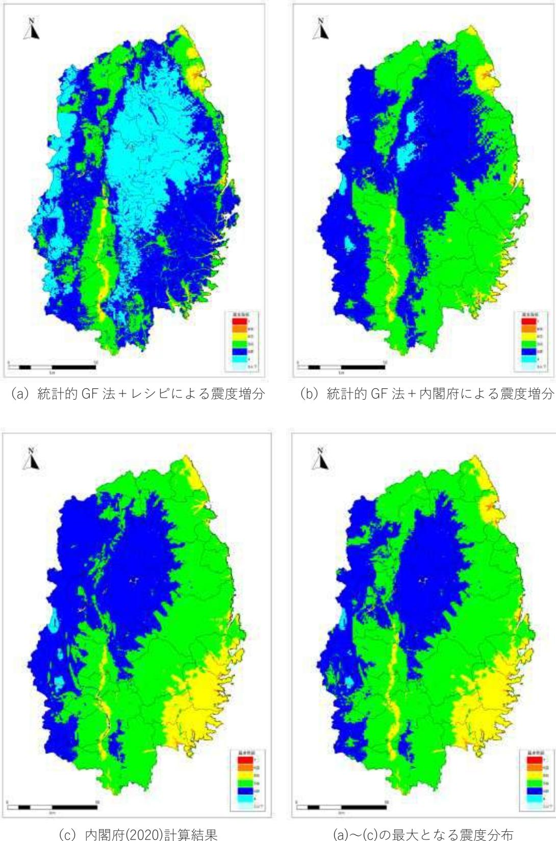
図 2.6.2-7 「日本海溝（三陸・日高沖）モデル」の地表震度分布図
