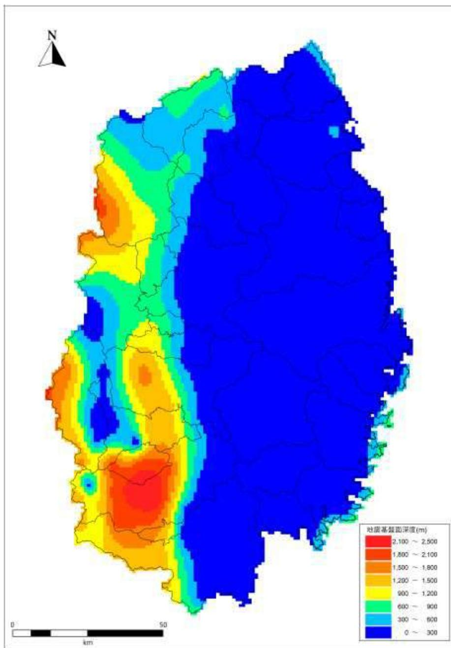
図 2.6.1-4 Vs2100m/s 層（地震基盤）の下面深度(m)
