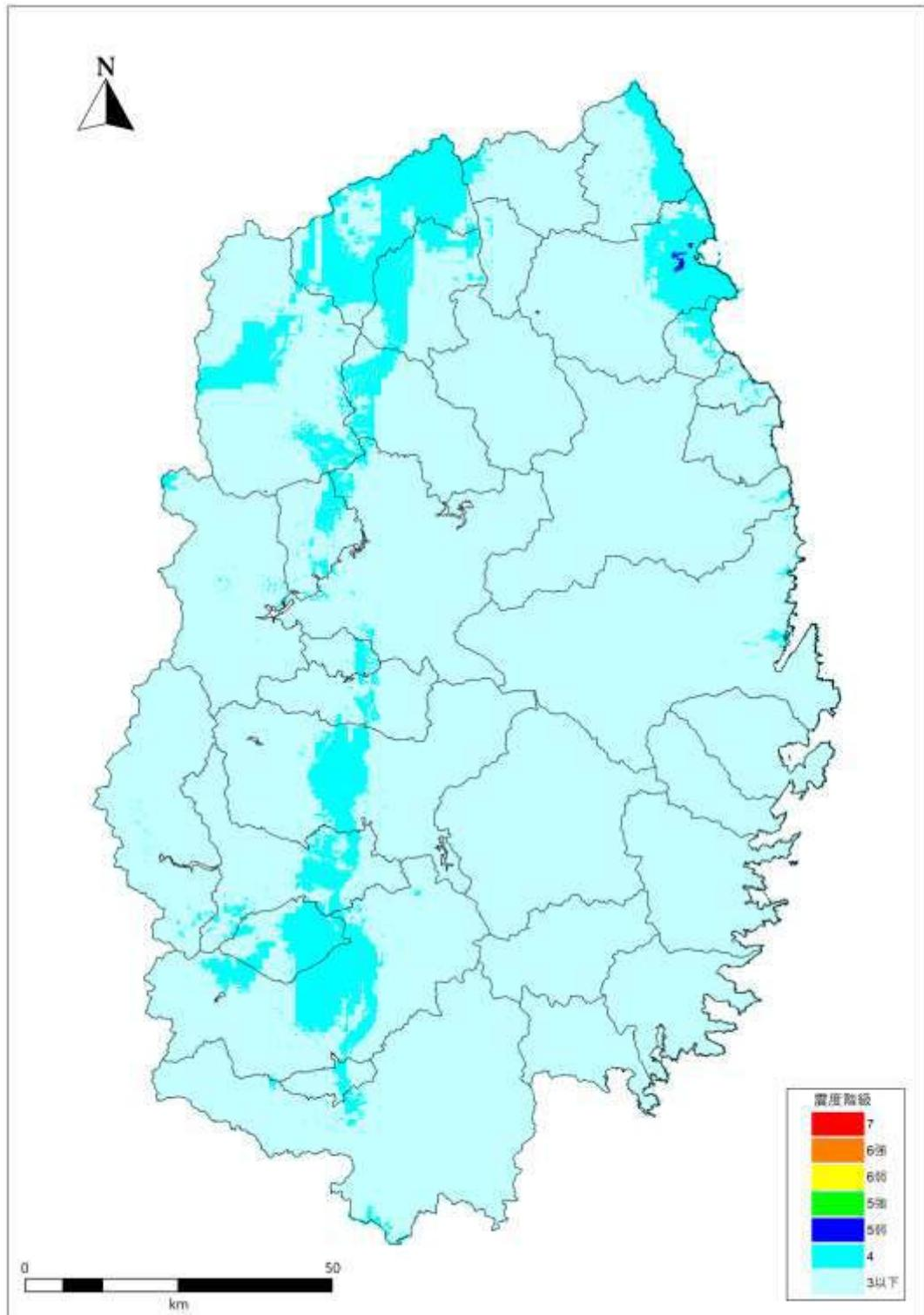
図 2.6.2-10 「千島海溝（十勝・根室沖）モデル」の最大となる地表震度分布図
