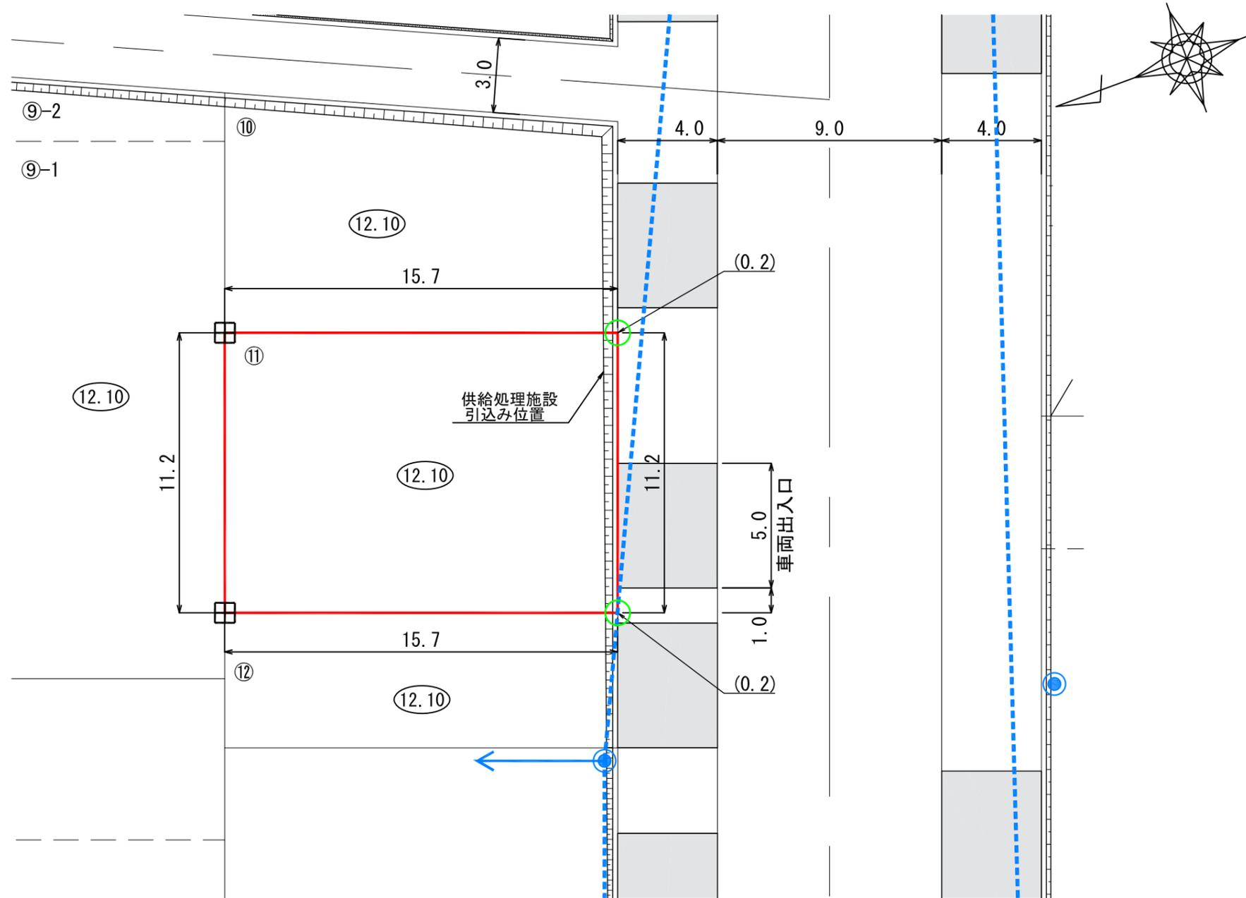
供給処理施設引込み位置図 S=1:100
