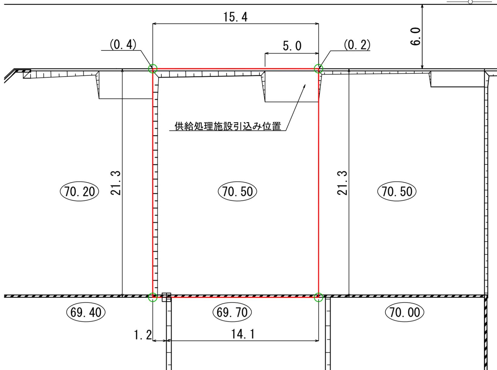
供給処理施設引込み位置図 S=1:100
