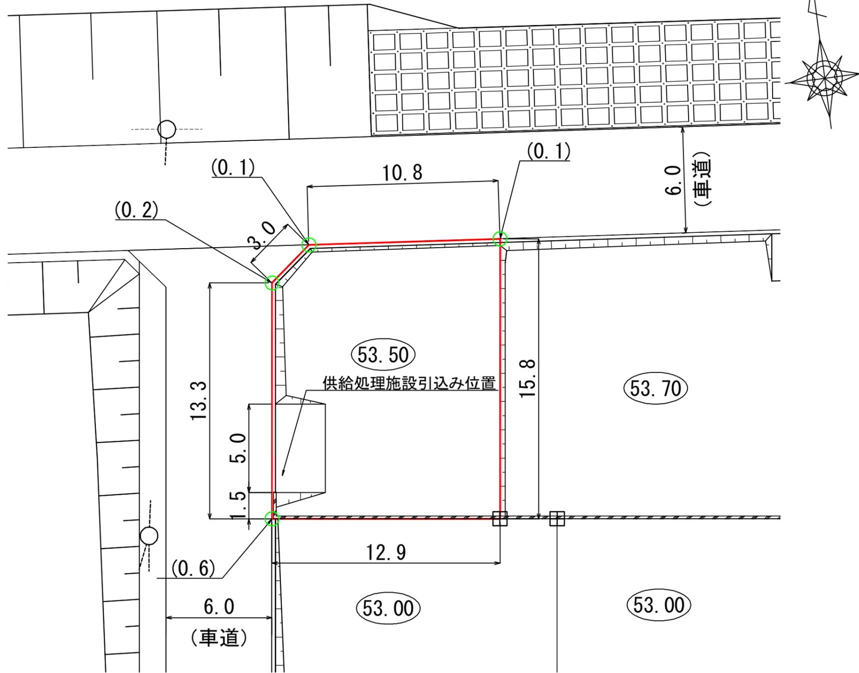
供給処理施設引込み位置図 S=1:100
