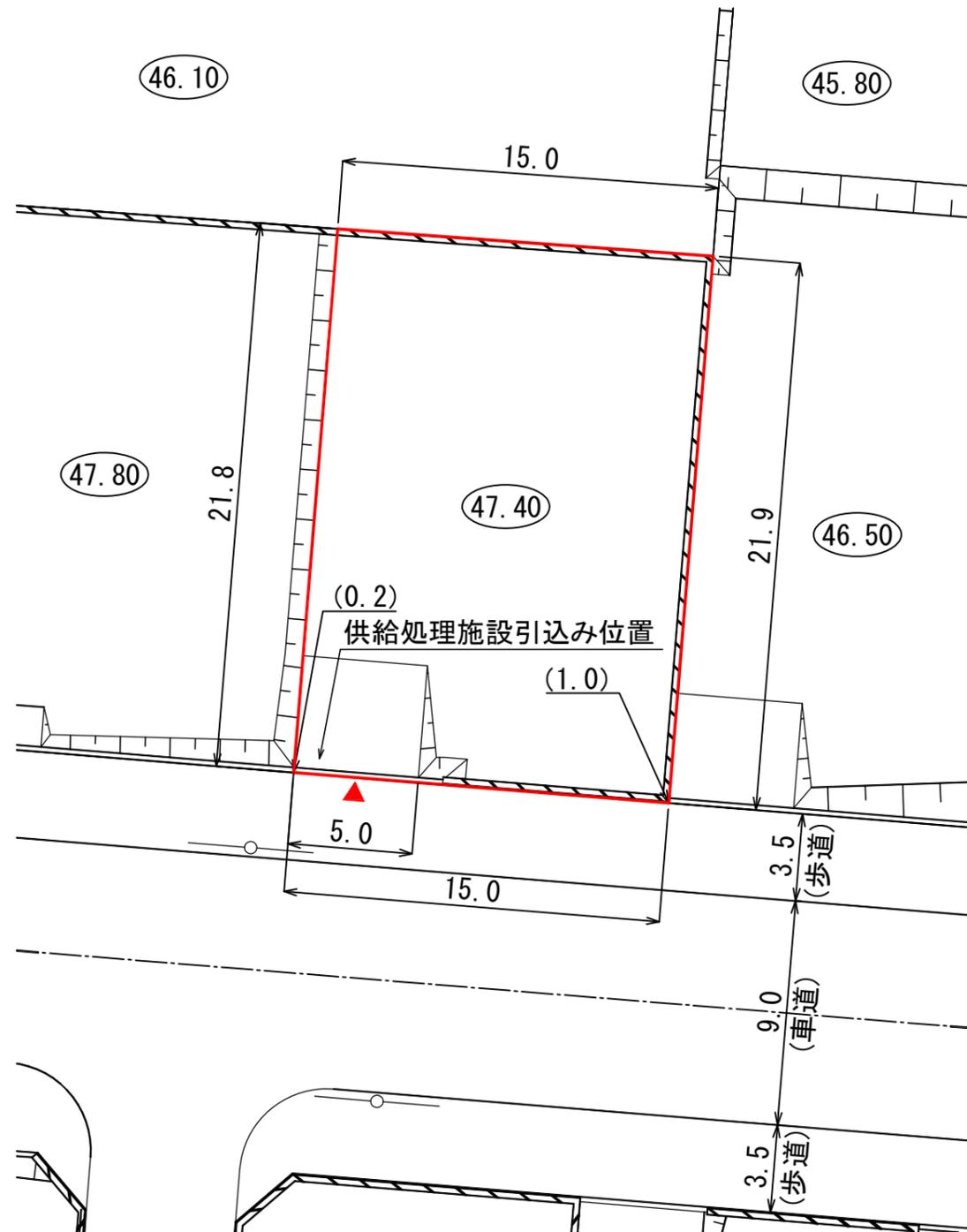
供給処理施設引込み位置図 S=1:100
