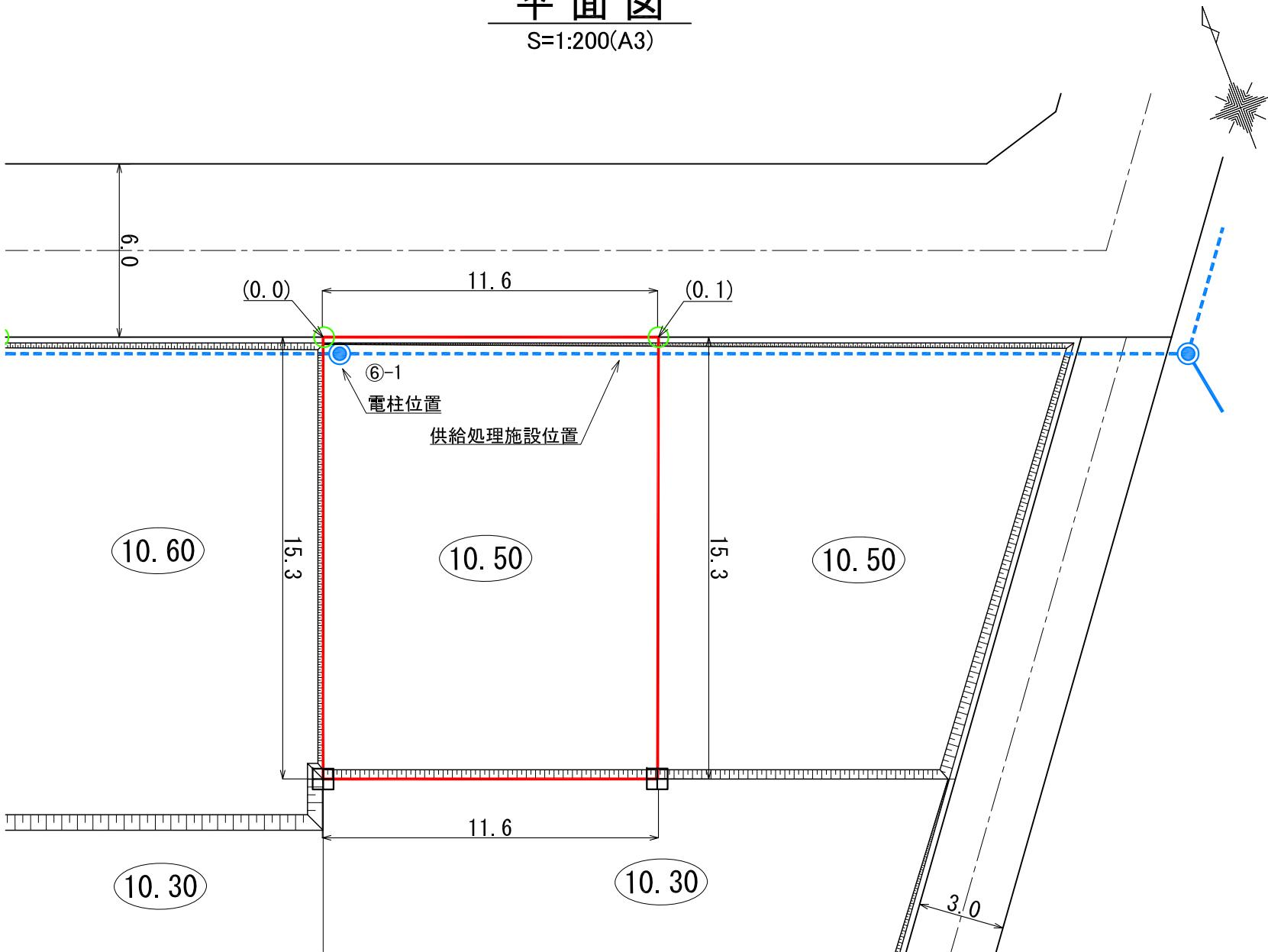
**供給処理施設、電柱位置図**
