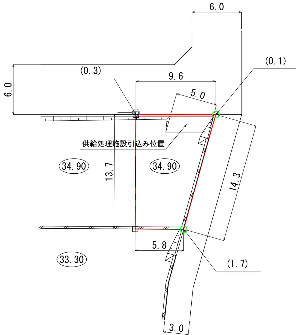
供給処理施設引込み位置図 S=1:100
